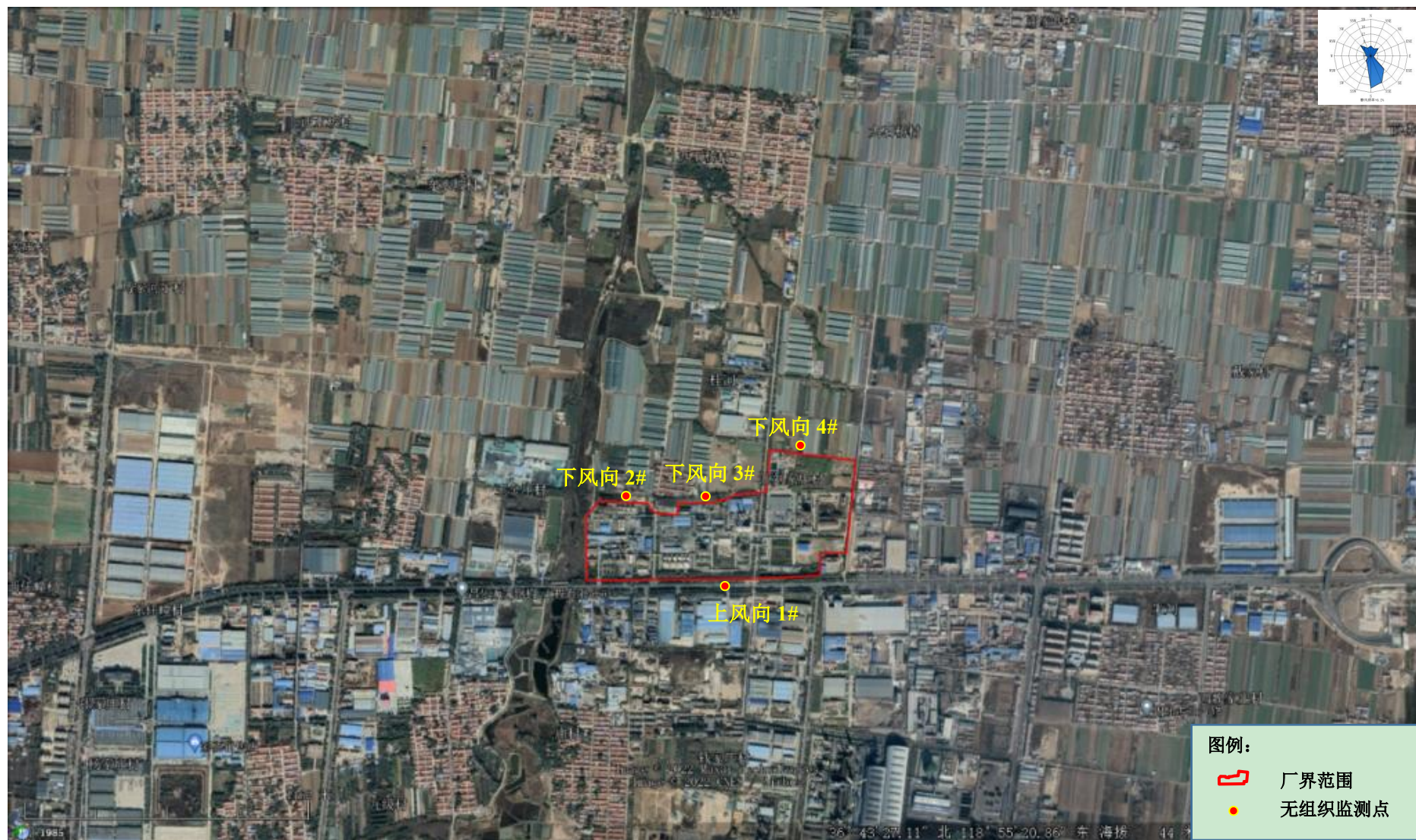
图 3.12-5a 厂界无组织废气监测点位图（监测日期：2024.04.02、2024.10.16）
